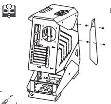
1. Для установки комплектующих открутите 2 винта и снимите боковую панель.
