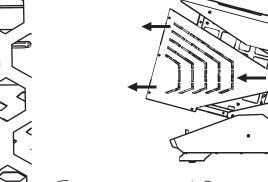
4. Открутите 10 винтов и снимите нижние и боковую панели.
