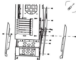
5. Открутите 4 винта и снимите нижнюю рамку крепления БП.
